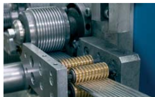
Цех изготовления гибких воздуховодов
