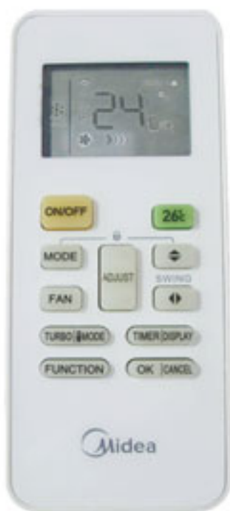
Пульт ДУ RG52 для кондиционеров всех полупромышленных серий и некоторых новых серий сплит-систем
